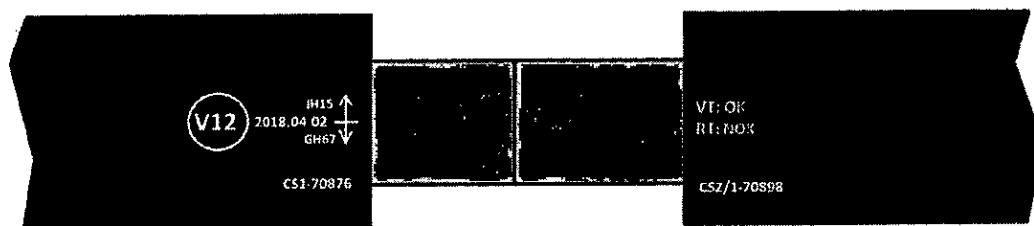
5.ábra: a varrat jelölése ha a VT vizsgálat megfelelt, de az RT vizsgálat nem felelt meg
